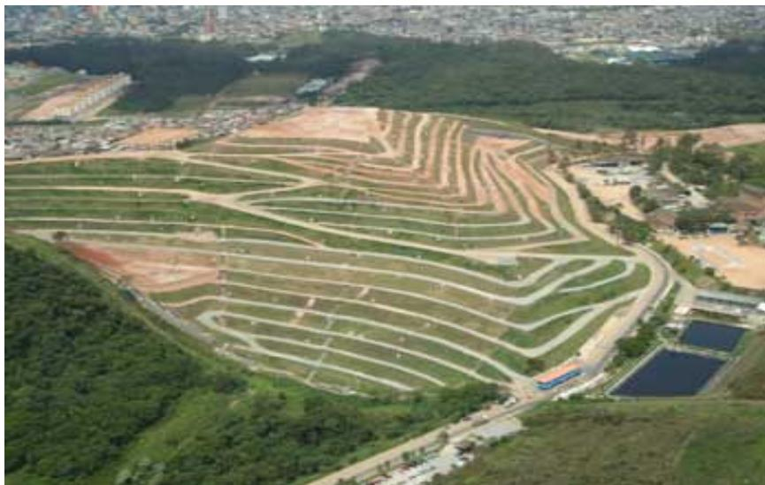
**Figura 10: Exemplo de aterro sanitário encerrado de modo adequado**
